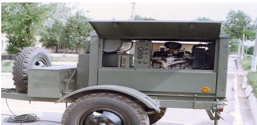
ADB-6120 rusumidagi elektryoyli (doimiy tokli) payvandlash a gregatining umumiy ko'rinishi.
