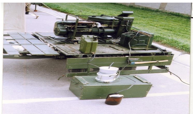
ESB-4VZ-1 zaryadlash va razryadlash agregatining umumiy ko'rinishi.
